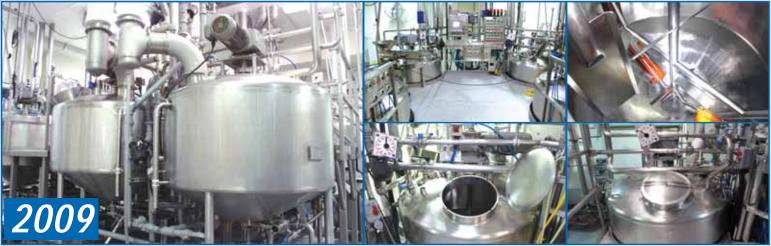
SAUCE COOKING SYSTEM - (6) INDUSTRIES D'ACIER 400 GALLON JACKETED PROCESSORS, DOUBLE MOTION SWEEP SCRAPE WITH BAFFLES, 75 PSI JACKET
